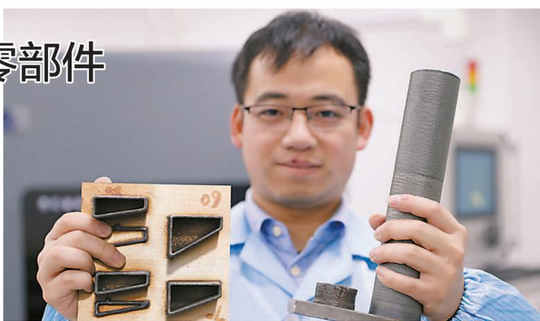
科研人员展示用同轴送丝激光金属3D打印机打印出来的零部件。 本报见习记者 赖鑫琳 摄
