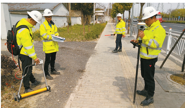
检测小分队正在工作。图左侧的设备是金属探测器,用来探测金属水管的方位和走向;图右侧的设备是GPS探测器,用来感应在水管内工作的“探针”。
