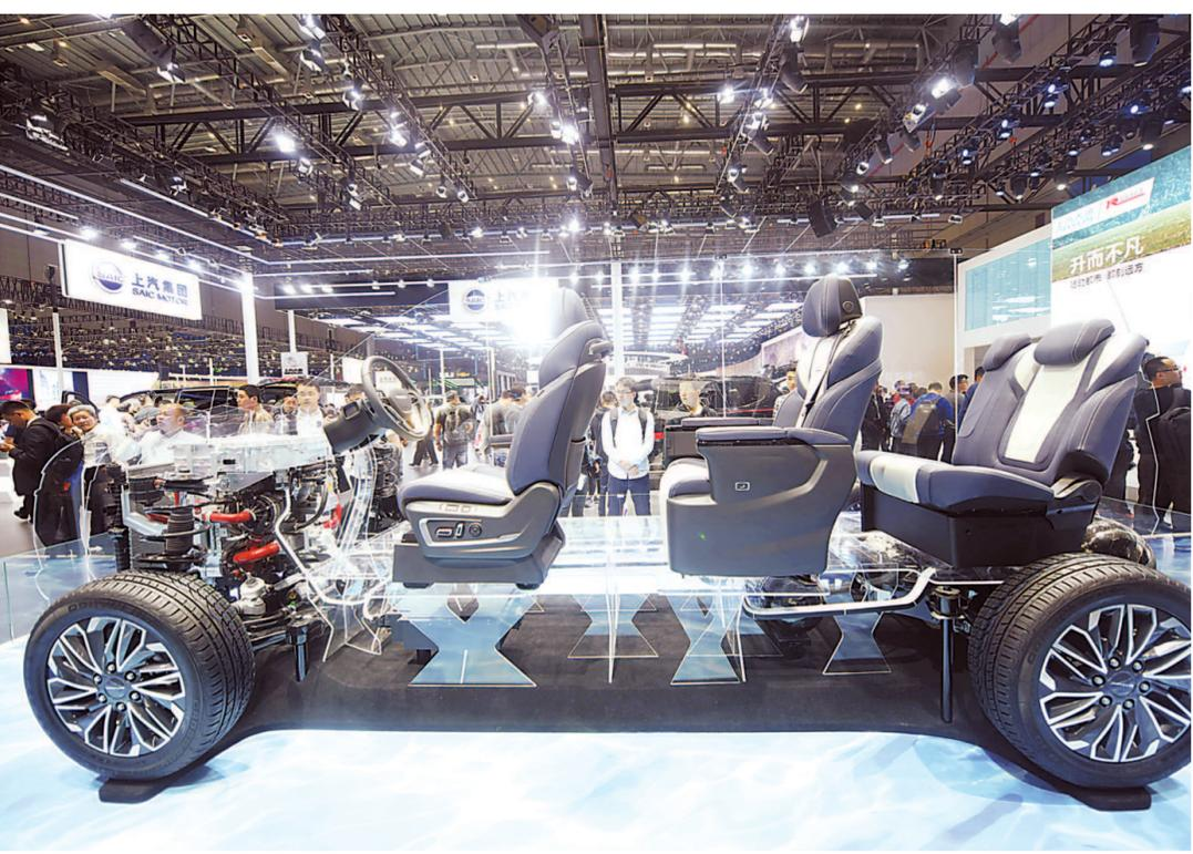
2019 上海国际车展上，国产氢燃料电池汽车亮相。参观者在观看国产氢燃料电池汽车 G20FC 的内部结构模型。 东方 IC 供图
