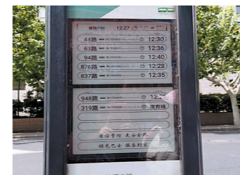
充分利用原设施改装电子站牌
