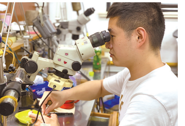
老凤祥技工在高倍显微镜下镶钻石。
