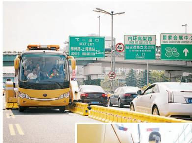
▲由大客车改造的“拉链车”能将隔离墩快速转换位置。▲“拉链车”的神奇装置。 均 海沙尔 摄
