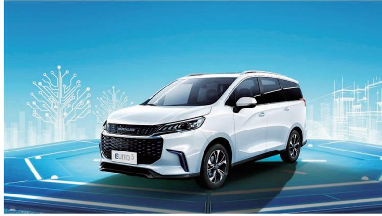
在混合动力方面,上汽 MAXUS 混合动力车型在纯电工况下的驱动效率将达到 92%,纯电续航里程超过 65km;而在混合动力工况下,驱动效率则将达到 51%,对比目前最先进的发动机,效率提升高达 30%。燃料电池则是上汽 MAXUS 引领行业发展的重要技术路线,到 2020 年,上汽 MAXUS 自主研发的第二代电堆系统的峰值输出功率将达到 115kW,并将率先应用于中大型 MPV 车型,加气时间只要 3 分钟,最大续航里程将超过 650km,几乎与燃油车无异。
