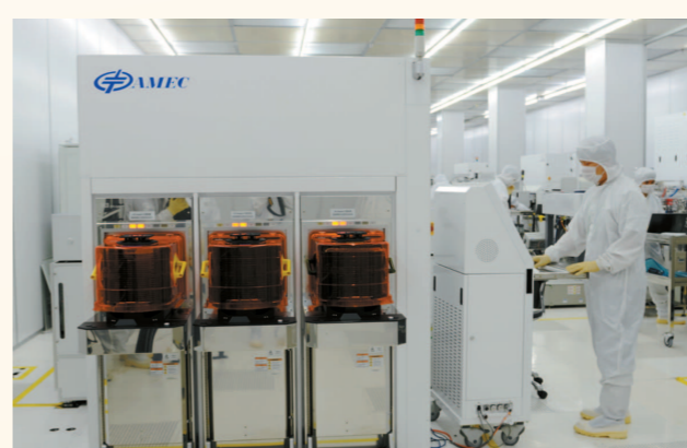
中微公司研发人员在操作等离子体蚀刻机。
