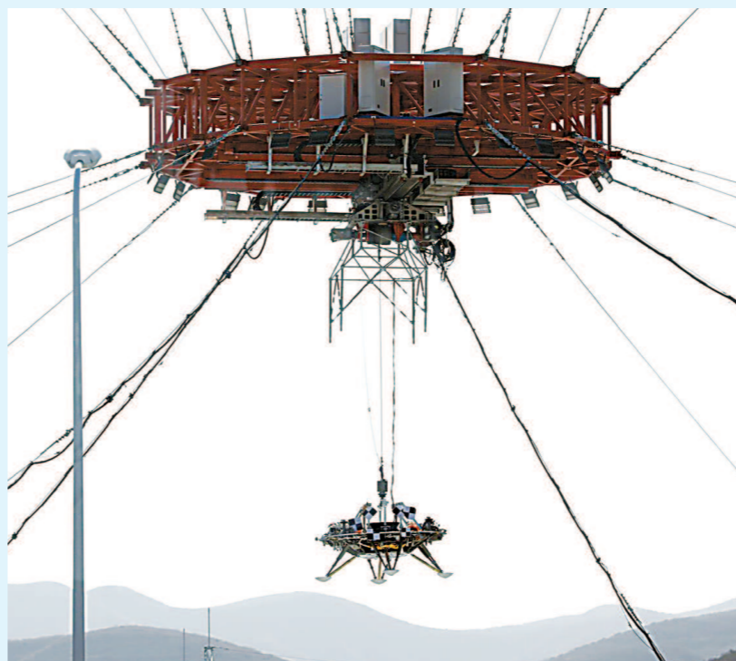
14日,我国首次火星探测任务着陆器悬停避障试验在河北省怀来县的地外天体着陆综合试验场完成。
