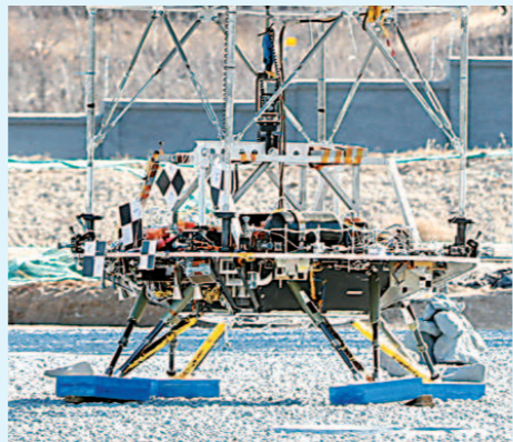
试验模拟了着陆器在火星环境下悬停、避障、缓速下降的过程。
