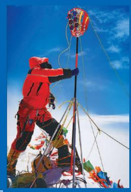
过去,珠峰测量是一个非常复杂的过程,以黄海之滨为起算点,一直测到珠峰脚下。有了北斗卫星导航系统,接收机通过卫星可获取峰顶觇标圆盘天线在地球表面的高度、冰层深度、大地高等信息。这是北斗系统在珠峰高程测量中首次应用
