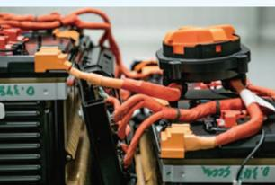
微蓝6 PHEV动力电池系统接触总成
