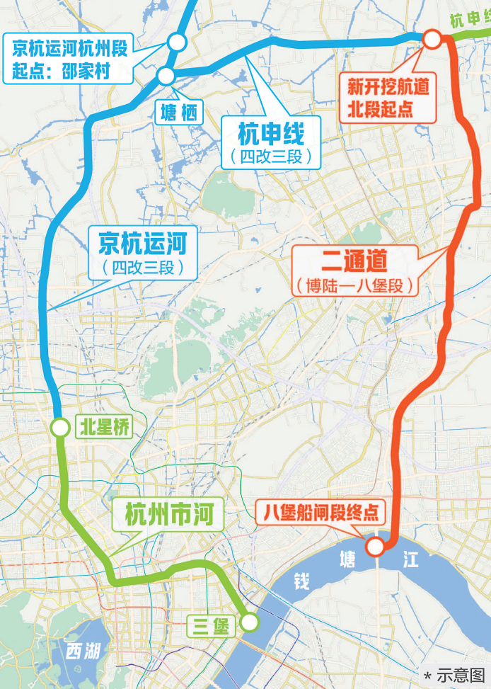
京杭运河杭州段（新开挖航道）线位图
