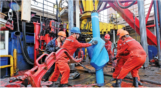
勘探四号平台井队正在组装底部钻具。
