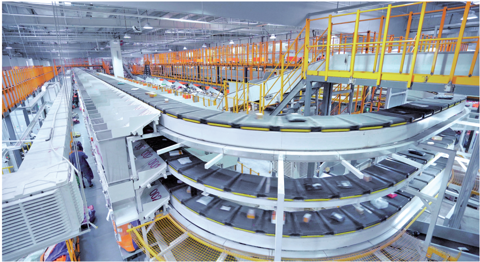
▲中通快递转运中心三层交叉带设备：中通持续投入新型超高速交叉带分拣设备，搭配自主研发的电控系统和操作系统，实现设备运行中能耗分配的极致高效。
