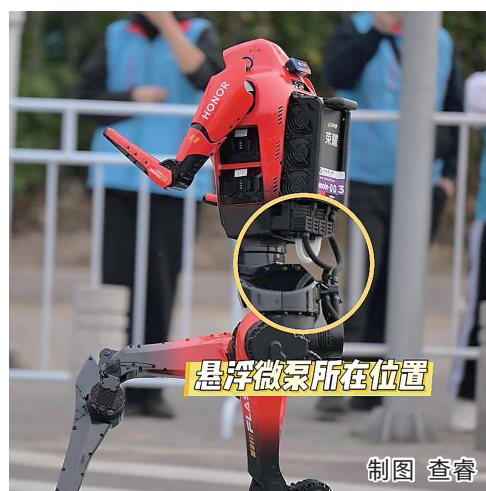
“闪电”机器人安装了液冷散热装置。
